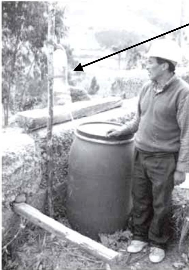
Botella con sistema para verificar la medición del biogás y asegurarse que el proceso funciona
