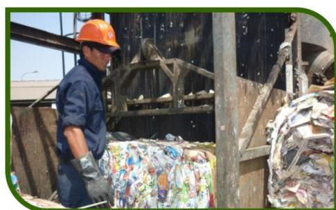
Acondicionamiento (desetiquetado, lavado, picado y prensado)
